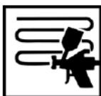
Aplicar 1 a 2 passadas com camada de 40 a 50 µm e distância de 5 cm da peça.
